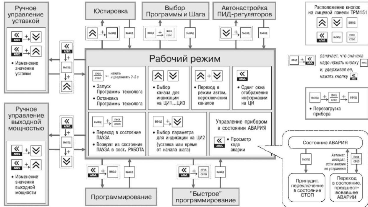
Рис. П. 4.7. Схема переключения режимов прибора
