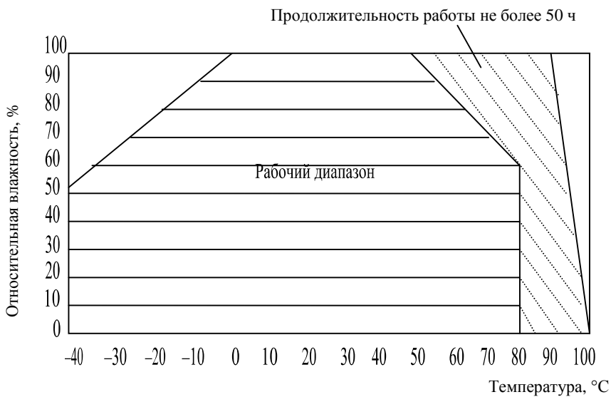
Рис. 4.7. Рабочий температурный диапазон датчика НИН-4000 относительной влажности
