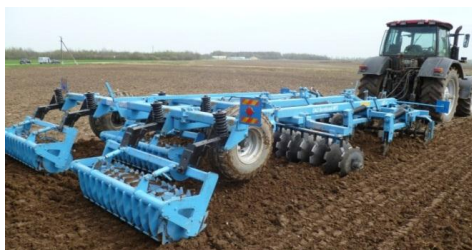
Рисунок 1. – Агрегат комбинированный для безотвальной обработки тяжелых почв АБТ-4
