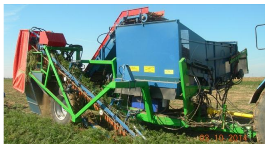
Рисунок 3. – Комбайн теребильного типа для уборки моркови КТМ-1
