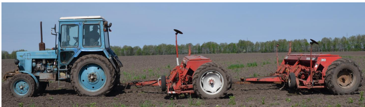
Рисунок 1 - Двоевалковый агрегат для ленточного внесения основных доз твердых минеральных удобрений, посева сельскохозяйственных культур и припосевого внесения удобрений стартовыми дозами
