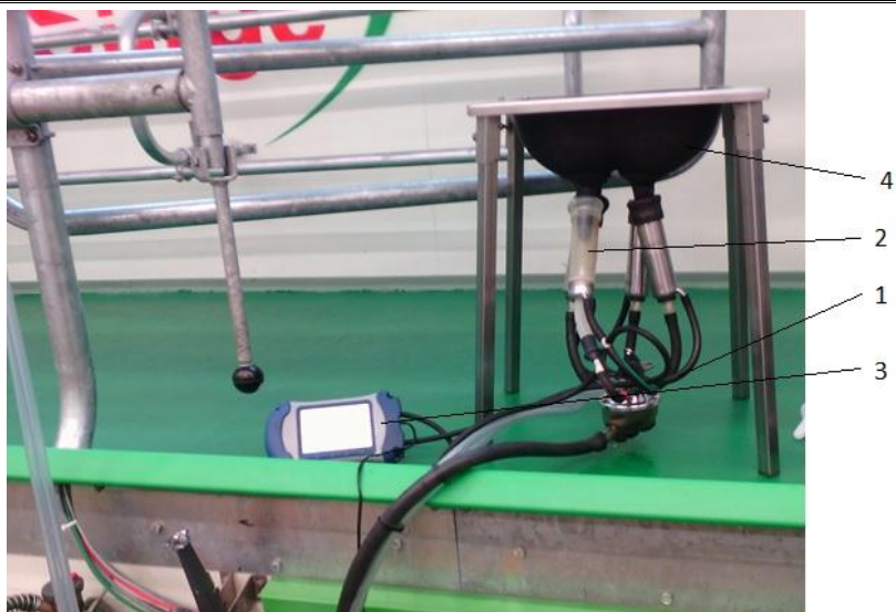
1 – доильный аппарат; 2 – экспериментальный доильный стакан; 3 – тестер VPR-100; 4 – искусственная вымя Рисунок 1 – Общий вид экспериментальной установки
