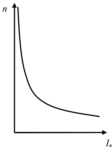
Рис. 8.3. Скоростная характеристика двигателя последовательного возбуждения
