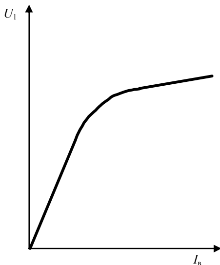
Рис. 15.4. Характеристика холостого хода
