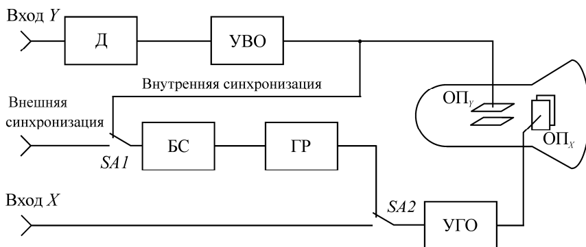
Рис. 5.3. Структурная схема электронно-лучевого осциллографа:
