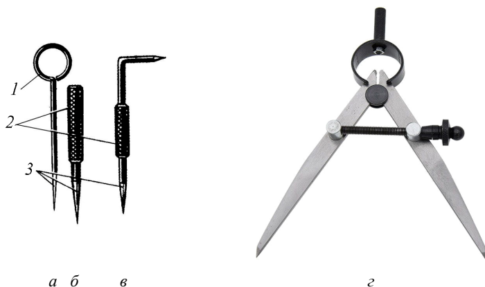
Рис. 1.1. Чертилки: а – с кольцом; б – со вставными иглами; в – с отогнутым концом; з – циркуль разметочный; 1 – кольцо; 2 – ручка; 3 – стержень
