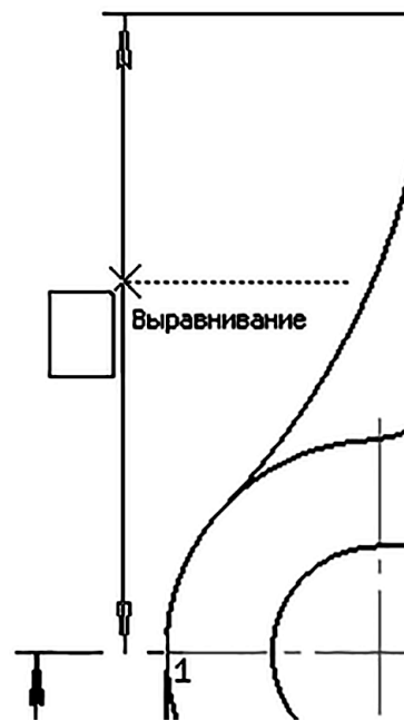
Рис. 61. Линейный размер, выровненный вертикально
