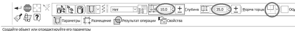
Рис. 152. Задание параметров команды Простое отверстие на Панели свойств
