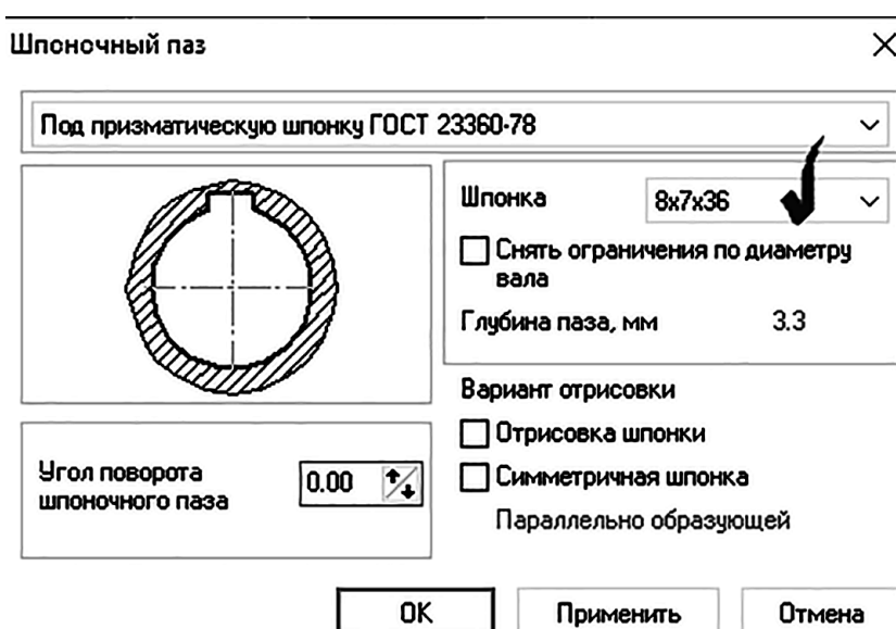
Рис. 233. Выбор параметров шпоночного паза
