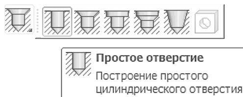
Рис. 151. Команда Простое отверстие
