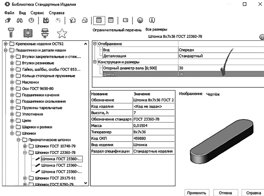
Рис. 248. Задание параметров шпонки
