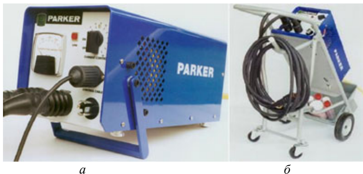
Рис. 5.9. Магнитные дефектоскопы Parker (США) а – Parker DA 750; б – Parker DA 1500
