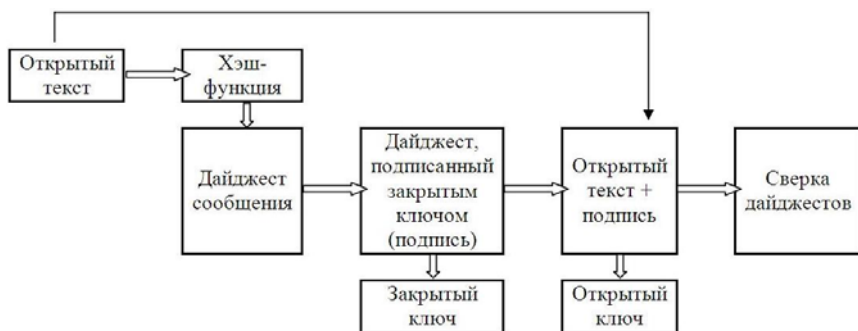
Рис. 5.5. Детализация процесса применения цифровой подписи
