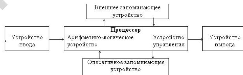
Рис. 1.1. Схема классической архитектуры ЭВМ
