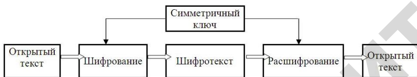
Рис. 5.2. Этапы шифрования с симметричным ключом
