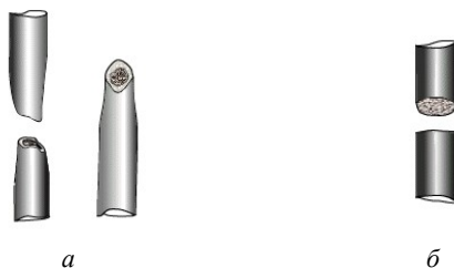
Рис. 2.4. Место разрушения образца: a – в виде кратера; б – по плоскости поперечного сечения
