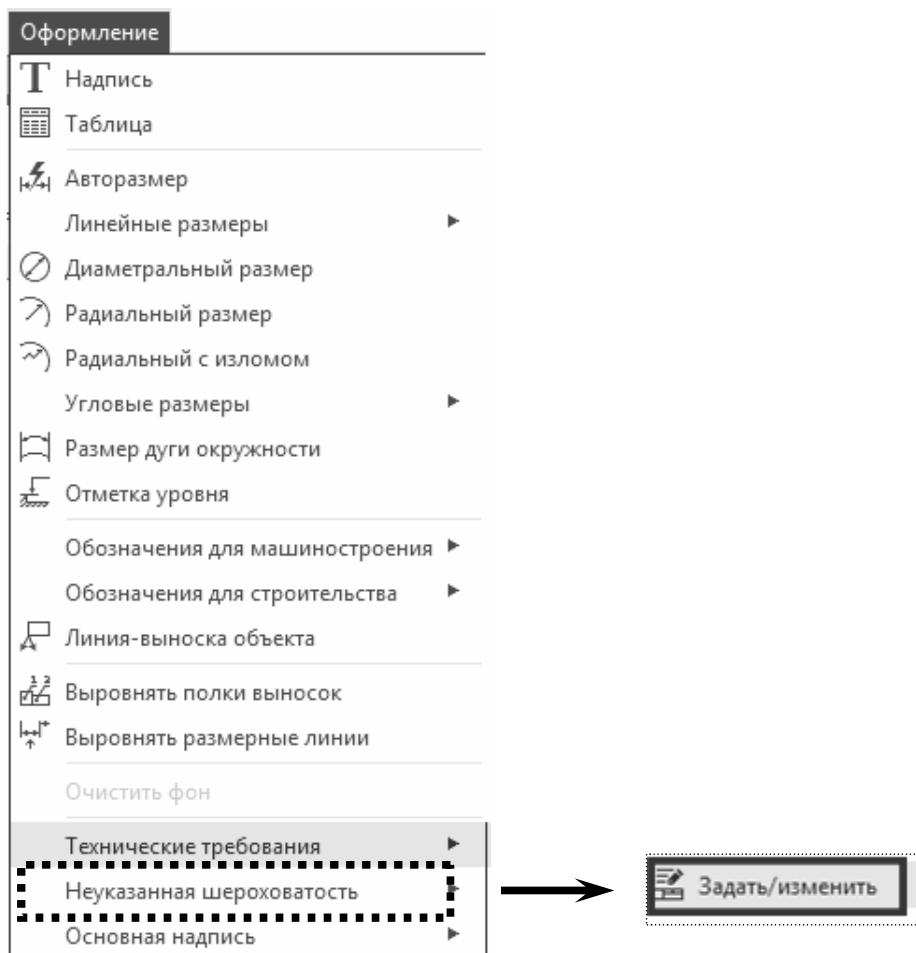
Рис. 3.14. Простановка знака неуказанной шероховатости
