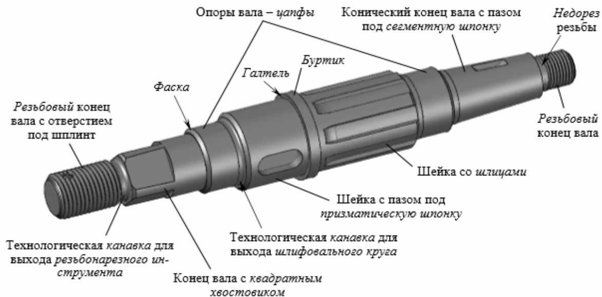
Рис. 15.1. Вал со ступенями разной формы с конструктивными и технологическими элементами
