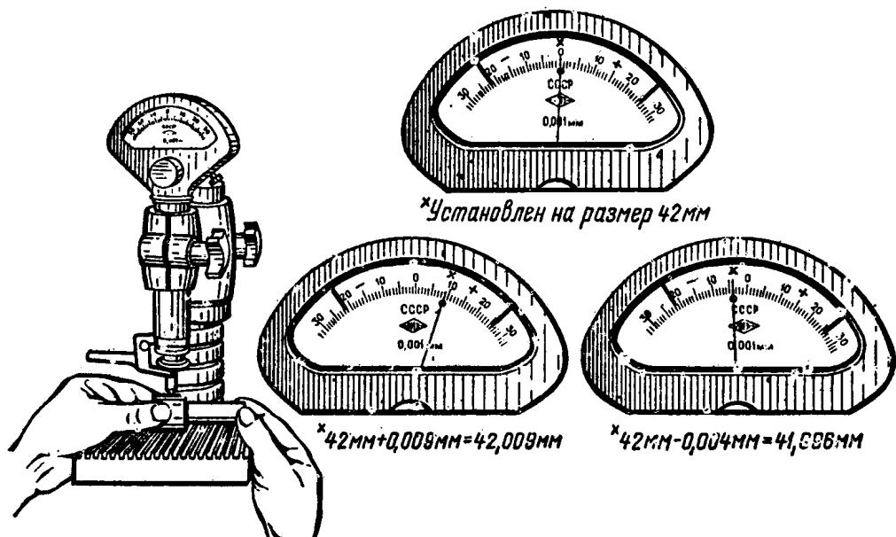
Рис. 1.2.71. Определение отклонений и подсчет действительных размеров
