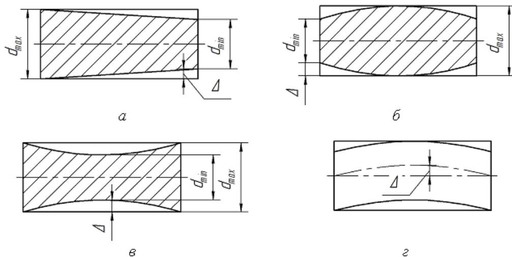
Рис. 2.1.6. Отклонения профиля в продольном сечении
