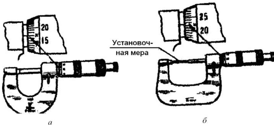
Рис. 1.2.27. Неправильное нулевое положение микрометра:
