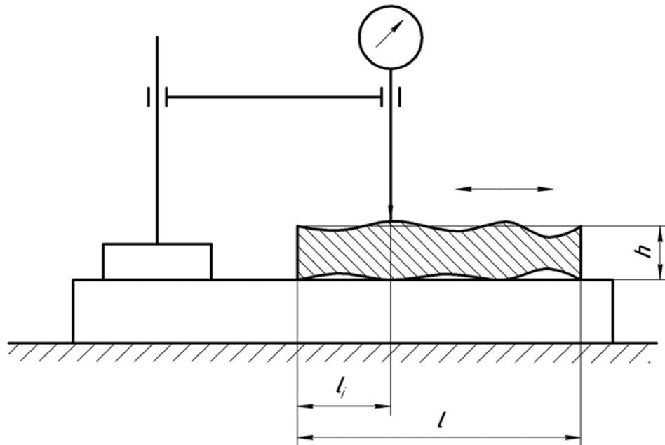
Рис. 2.2.1.2. Контроль прямолинейности измерительной головкой
