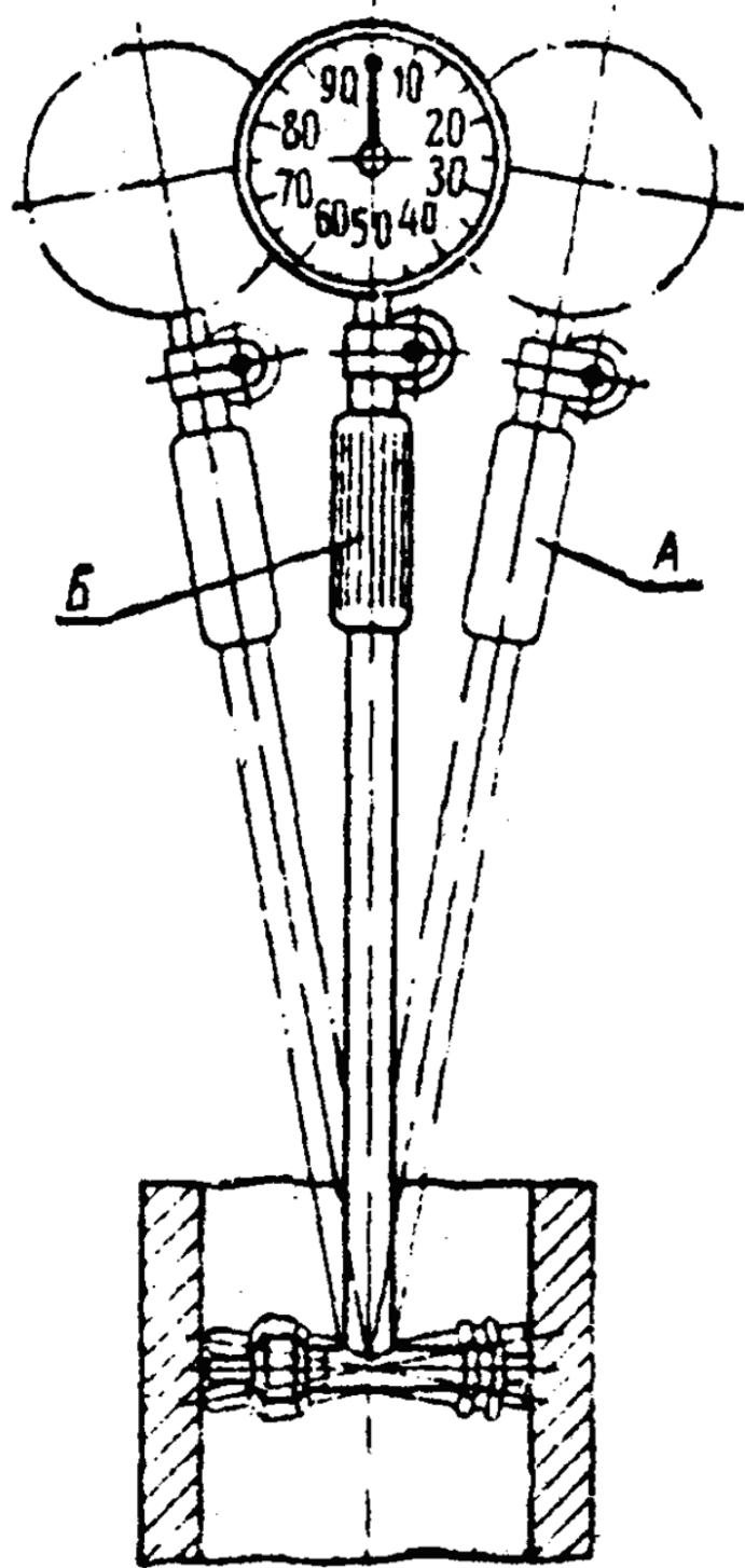
Рис. 1.2.56. Положение индикаторного нутромера при измерениях
