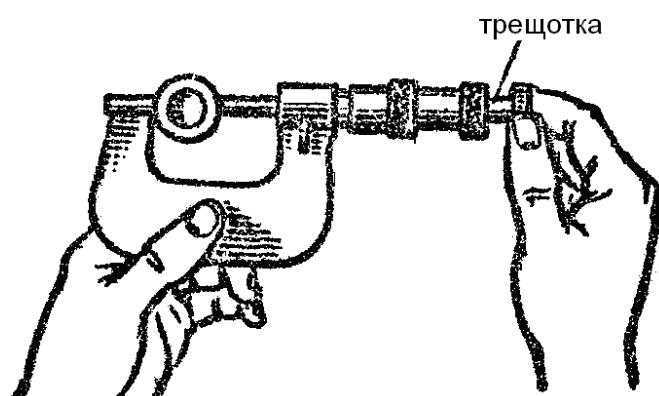
*Рис. 1.2.31. Измерение при горизонтальном положении оси микрометра*
