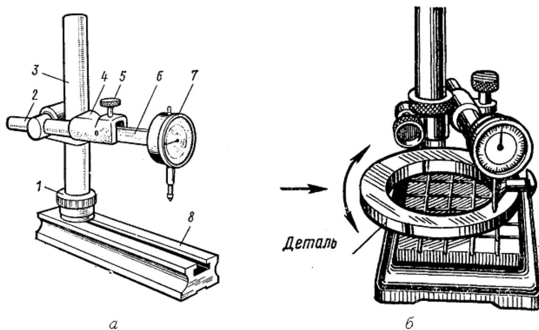
Рис. 1.2.52. Общий вид штатива и стойки:
