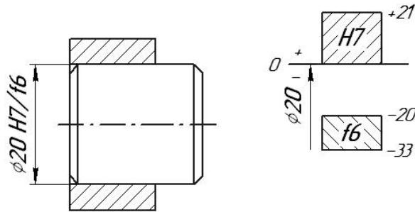
Параметры отверстия:  $ES = +21$  мкм,  $EI = 0$  мкм,  $T_D = 21$  мкм.
