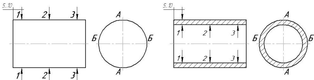
Рис. 1.3.1. Схема измерений размеров гладких наружных (а) и внутренних (б) цилиндрических поверхностей
