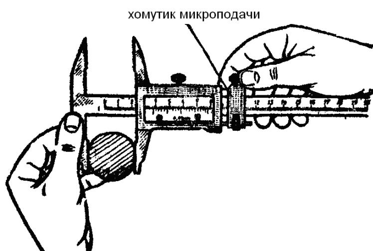
*Рис. 1.2.6. Закрепление хомутика микрометрической подачи*
