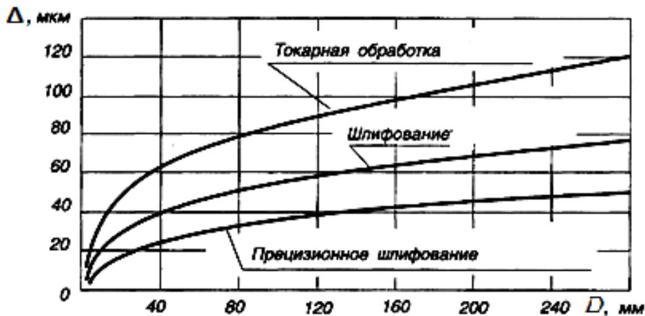
Рис. 1.1.11. Зависимость погрешности  $\Delta$  изготовления цилиндрических металлических деталей от способа обработки и диаметра  $D$
