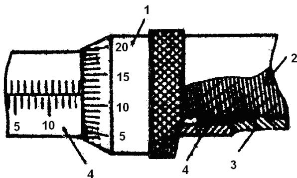
*Рис. 1.2.23.* Отсчетное устройство и принцип его действия:
