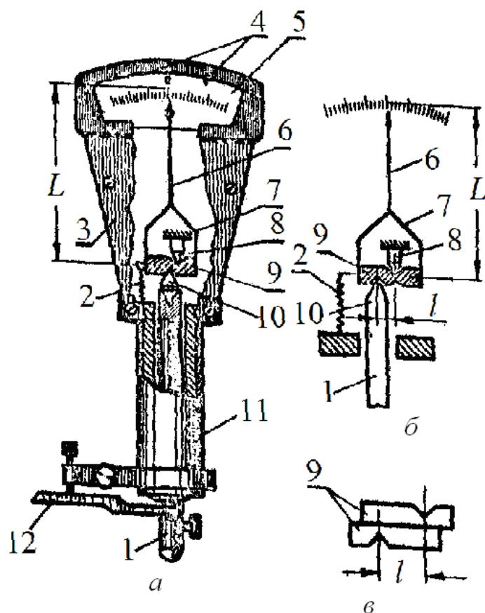
Рис. 1.2.67. Головка миниметра в разрезе ( $a$ ), принципиальная схема головки ( $b$ ) и составная призма ( $c$ ):
