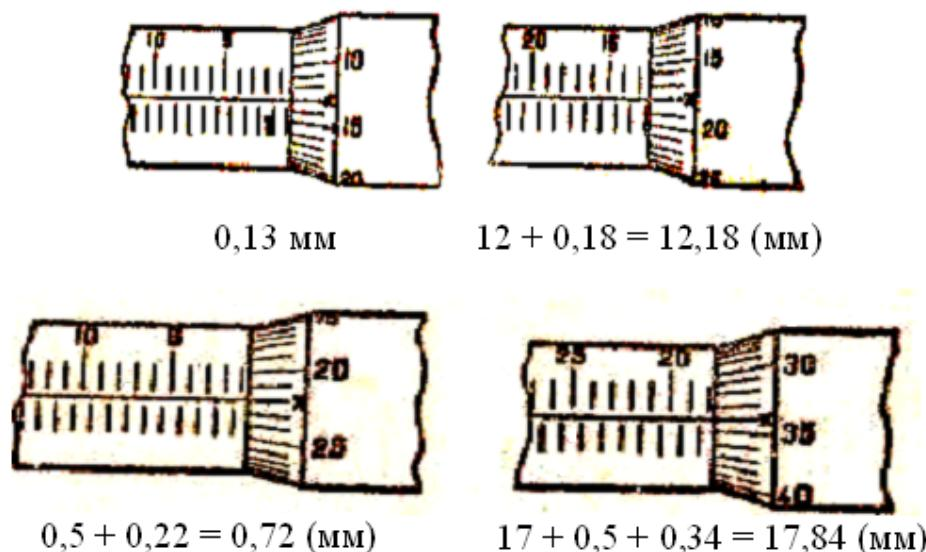
*Рис. 1.2.45. Чтение показаний микрометрического глубиномера*
