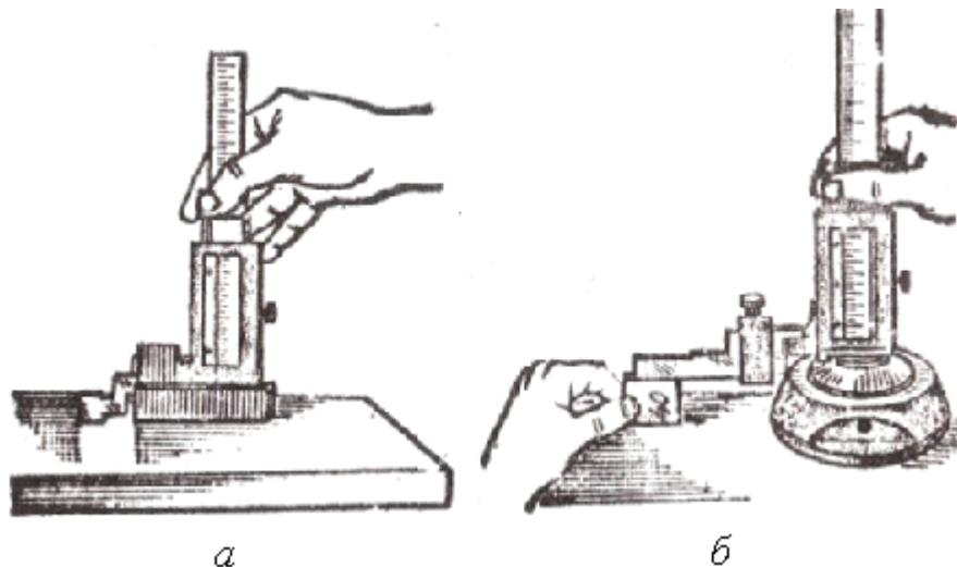
*Рис. 1.2.20. Проверка нулевого положения штангенрейсмусов с пределами измерений:
