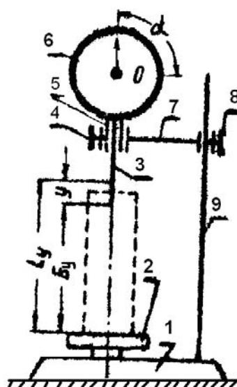
Рис. 1.2.51. Принципиальная схема устройства приборов для относительных измерений наружных поверхностей
