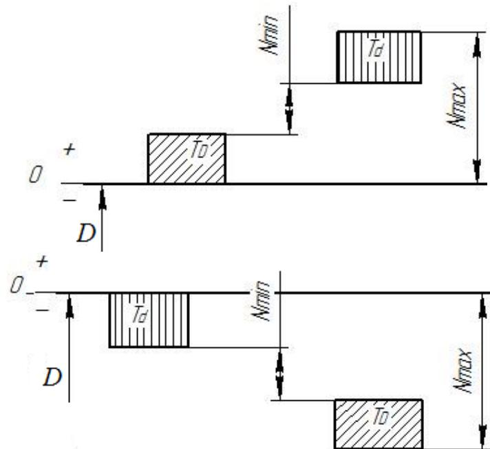
Рис. 1.1.5. Посадка с натягом и схемы расположения полей допусков
