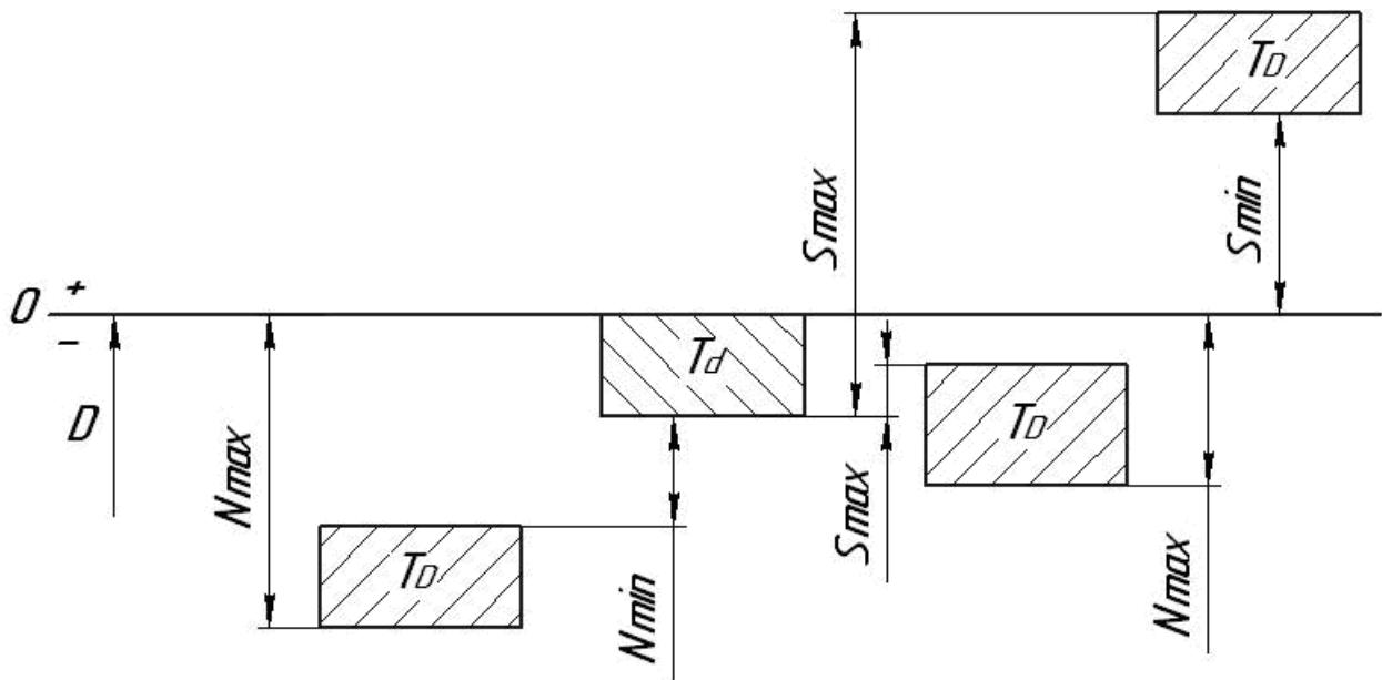
Рис. 1.1.8. Посадки в системе вала и схемы расположения полей допусков
