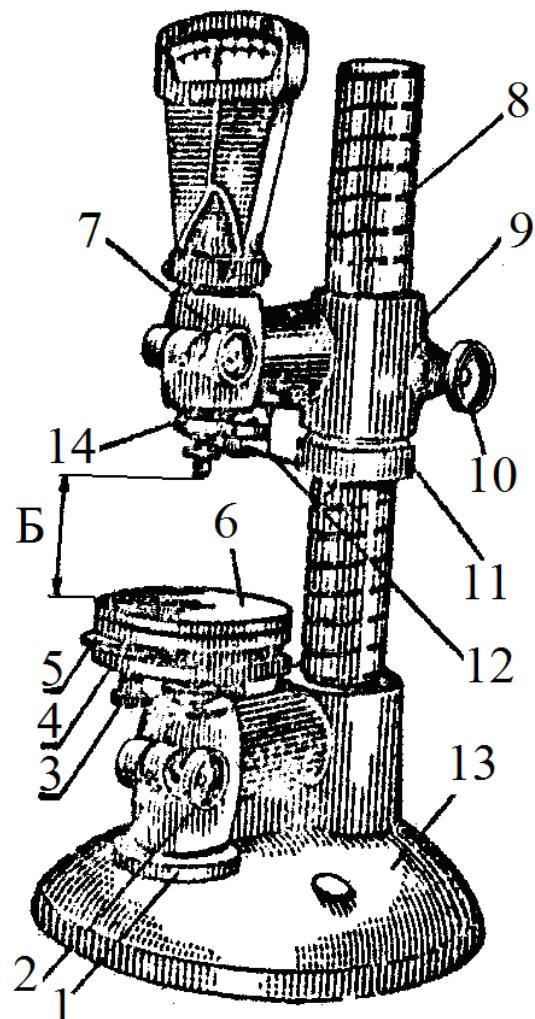
*Рис. 1.2.68. Вертикальная стойка тяжелого типа с регулируемым столом:*
