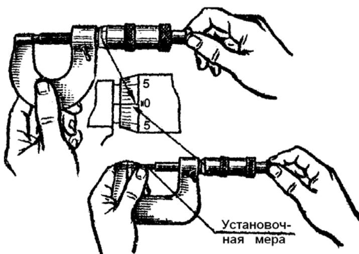
*Рис. 1.2.26. Проверка нулевого положения микрометра*
