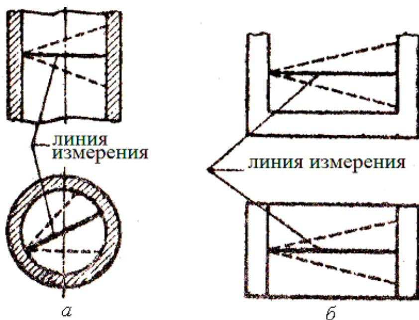
*Рис. 1.2.40.* Положение измерительных поверхностей микрометрического нутромера:
