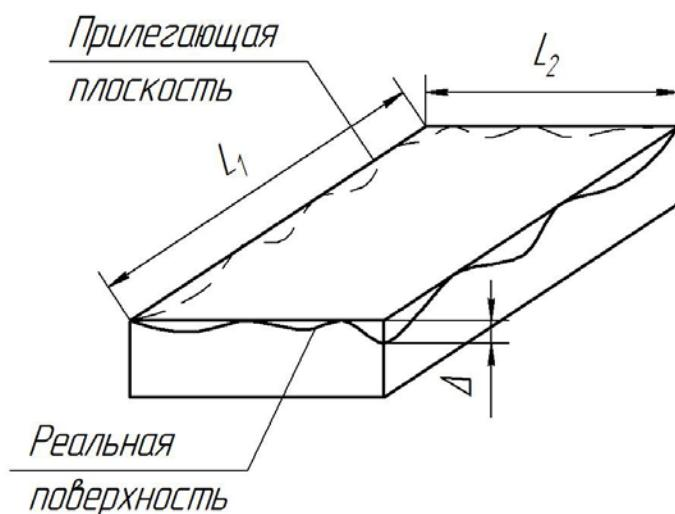
Рис. 2.1.4. Прилегающая плоскость
