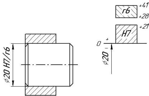
Параметры отверстия:  $ES = +21$  мкм,  $EI = 0$  мкм,  $T_D = 21$  мкм.
