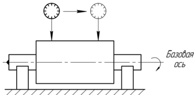
*Рис. 2.2.2.2. Измерение отклонений формы профиля в продольном сечении измерительной головкой*
