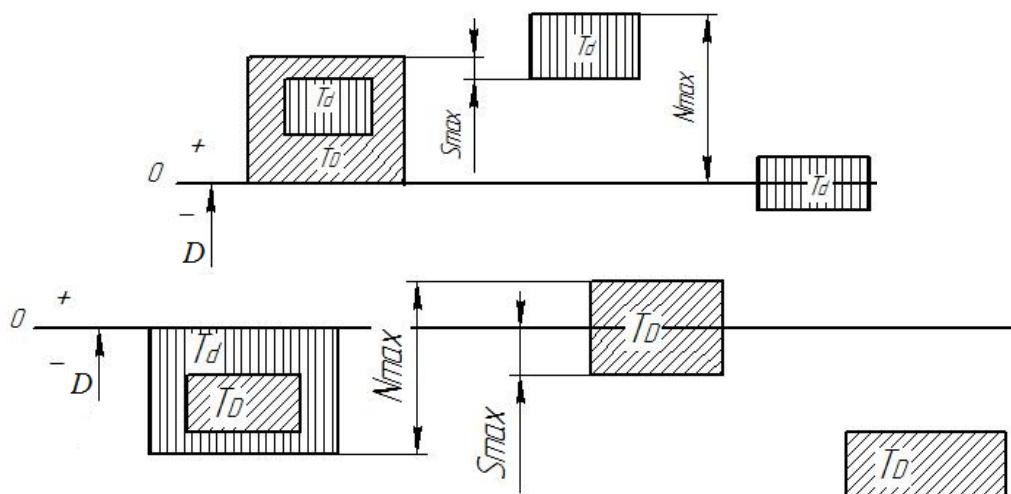
Рис. 1.1.6. Переходная посадка и схемы расположения полей допусков
