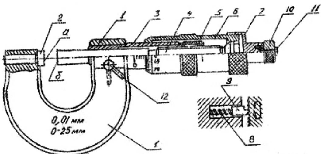
Рис. 1.2.25. Микрометр гладкий:
