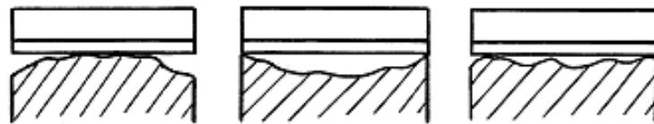
Рис. 2.2.1.1. Контроль прямолинейности лекальной линейкой
