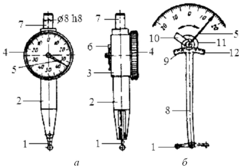
Рис. 1.2.73. Рычажно-зубчатый индикатор (а) и его схема (б):
