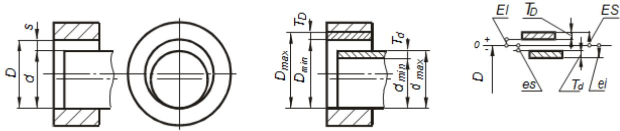
Рис. 1.1.3. Посадка с зазором и схема расположения полей допусков
