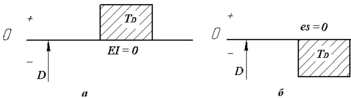
Рис. 1.1.9. Расположение поля допуска основной детали:
