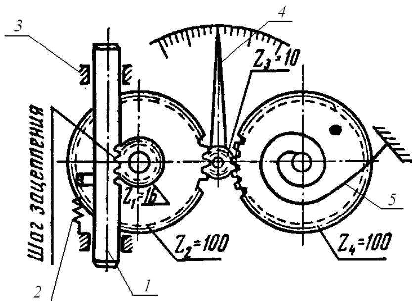
*Рис. 1.2.50.* Схема индикатора часового типа:
