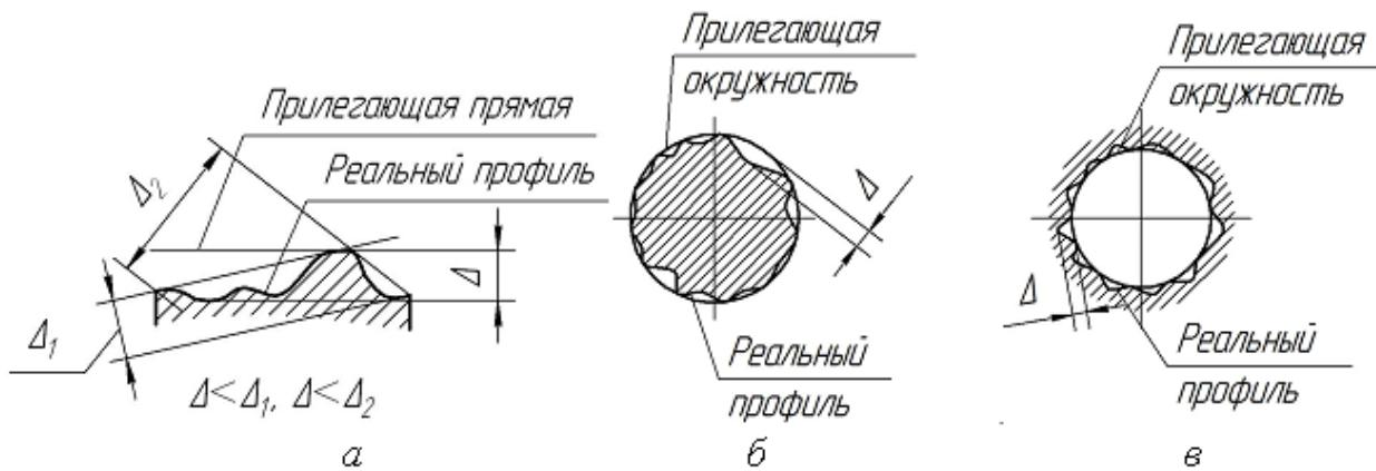
Рис. 2.1.2. Расположение прилегающей прямой ( $a$ ) и прилегающих окружностей ( $b, c$ )
