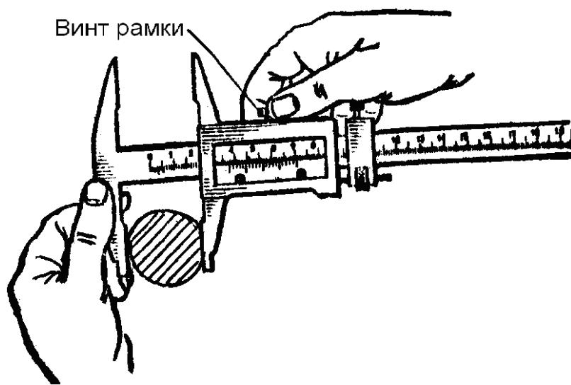
Рис. 1.2.8. Закрепление рамки
