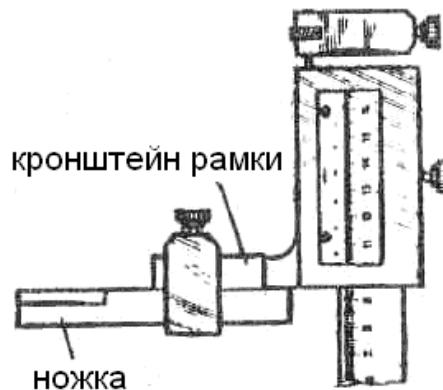
*Рис. 1.2.19. Расположение ножки в держателе*
