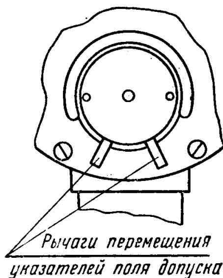
Рис. 1.2.72. Рычаги перемещения указателей отклонений микрокатора
