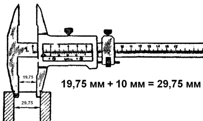
Рис. 1.2.10. Чтение показаний при внутренних измерениях
