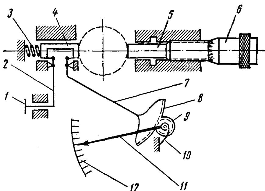
Рис. 1.2.61. Схема рычажного микрометра:
