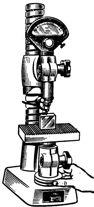
Рис. 1.2.70. Микронастройка микрокатора – перемещение измерительного столика
