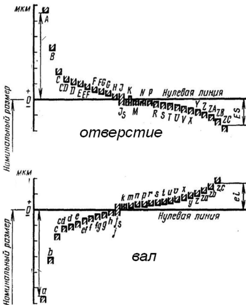
Рис. 1.1.12. Схемы расположений полей допусков валов и отверстий
