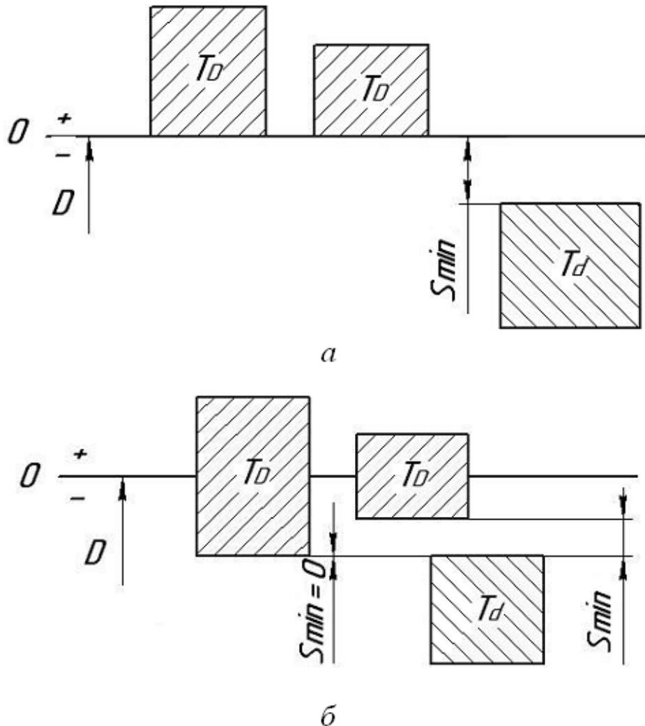
Рис. 1.1.10. Асимметричное (а) и симметричное (б) расположения поля допуска основной детали
