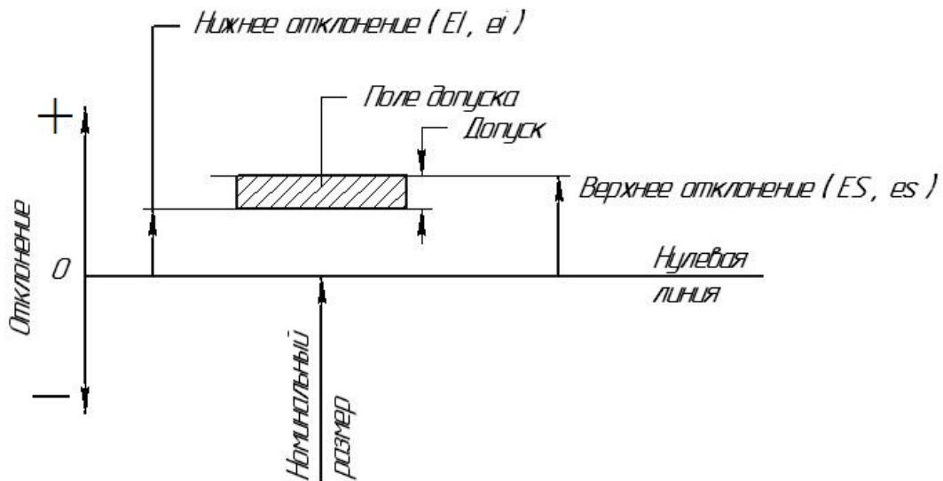
Рис. 1.1.2. Схема расположения поля допуска
