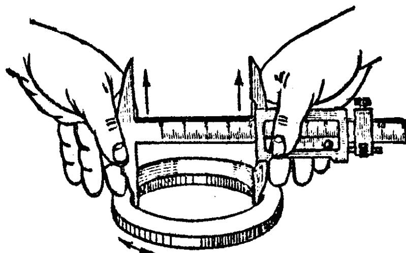
Рис. 1.2.9. Проверка на ощущение измерительного усилия при измерении большого внутреннего диаметра
