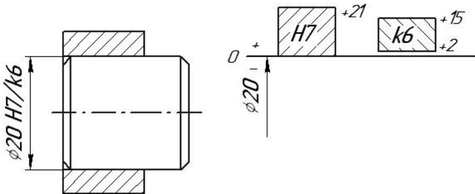
Параметры отверстия:  $ES = +21$  мкм,  $EI = 0$  мкм,  $T_D = 21$  мкм.
