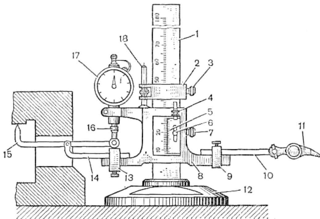
*Рис. 1.2.18. Штангенрейсмус с индикаторным устройством*
