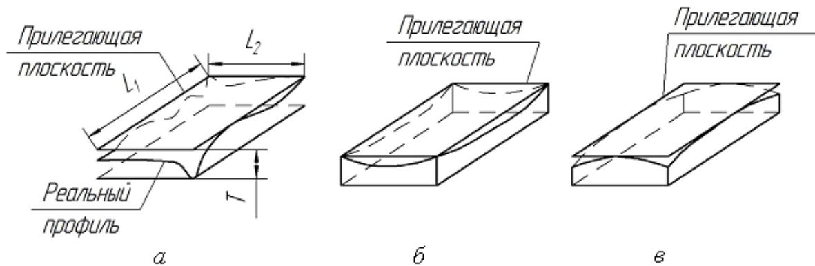
Рис. 2.1.7. Отклонения формы плоских поверхностей:
