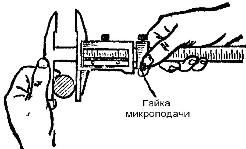
Рис. 1.2.7. Вращение гайки микрометрической подачи
