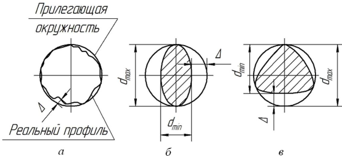
Рис. 2.1.5. Отклонения формы цилиндрической детали в поперечном сечении:
