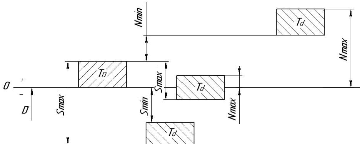
*Рис. 1.1.7. Посадки в системе отверстия и схемы расположения полей допусков*
