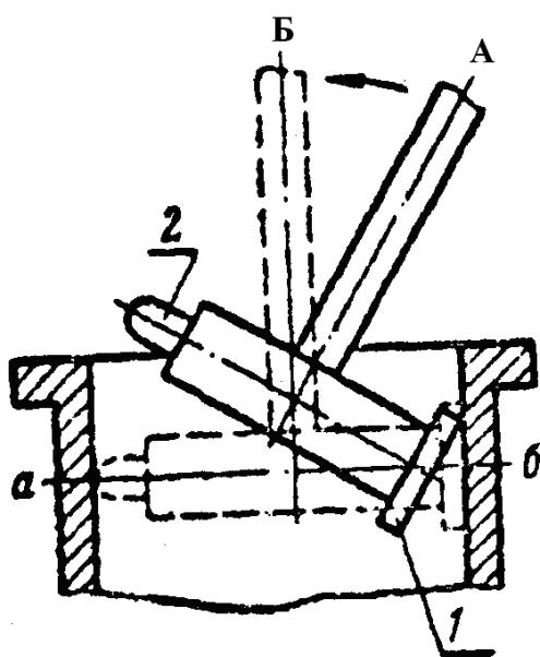
Рис. 1.2.55. Схема, иллюстрирующая порядок ввода индикаторного нутромера в отверстие
