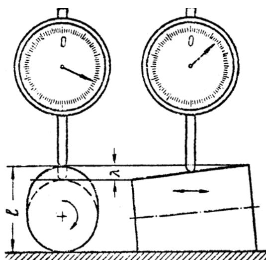
*Рис. 1.2.53. Схема измерения отклонения от заданной геометрической формы деталей*
