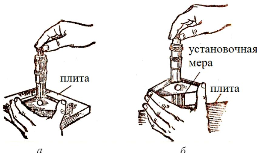
*Рис. 1.2.44. Проверка нулевого положения микрометрического глубиномера:
