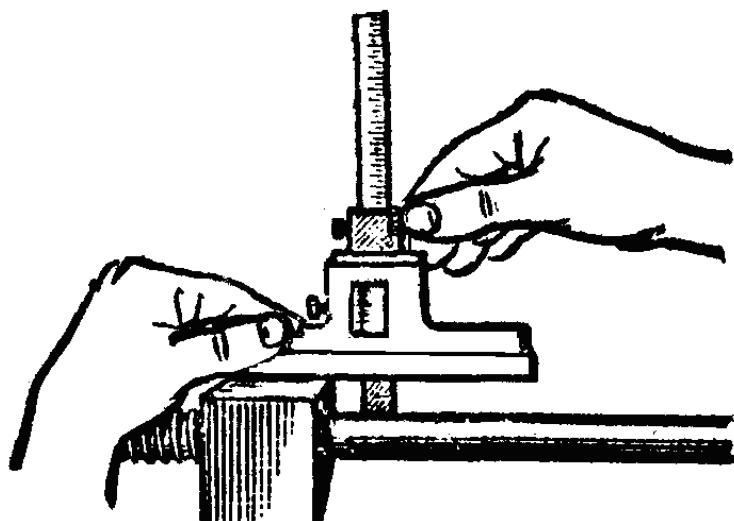
Рис. 1.2.16. Измерение штангенглубиномером
