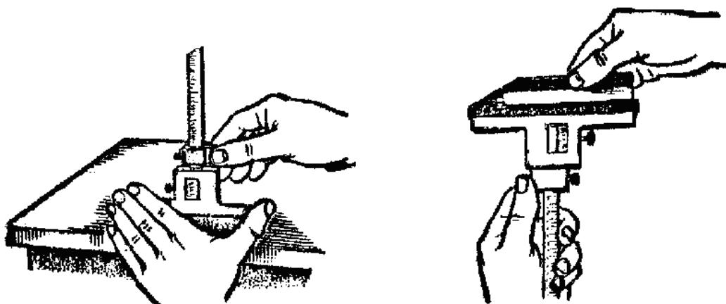
*Рис. 1.2.14. Проверка нулевого положения штангенглубиномера*
