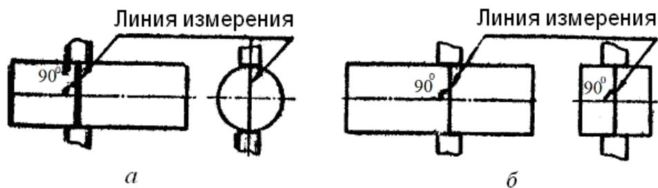
*Рис. 1.2.30. Положение измерительных поверхностей микрометра относительно измеряемых поверхностей:*
