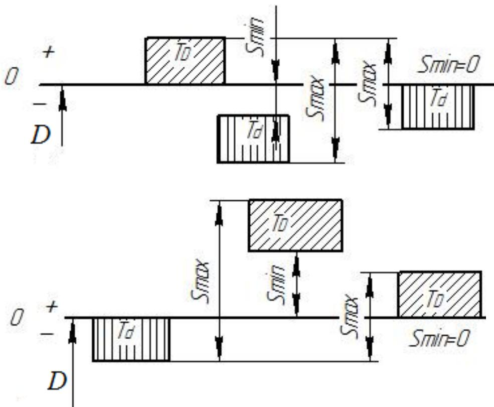
Рис. 1.1.4. Посадка с зазором и схемы расположения полей допусков
