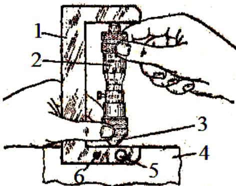
*Рис. 1.2.37. Проверка нулевой установки микрометрического нутромера:*
