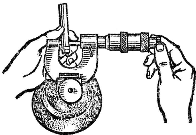
Рис. 1.2.33. Измерение микрометром, закрепленным в стойке
