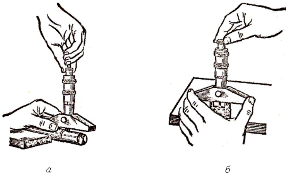
Рис. 1.2.46. Измерение микрометрическим глубиномером:
