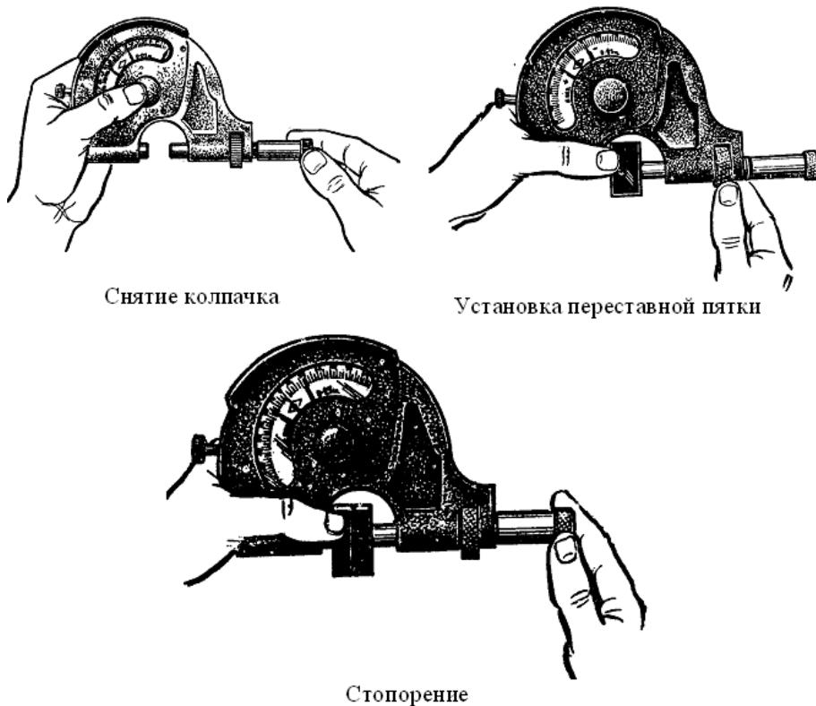
*Рис. 1.2.65. Настройка рычажной скобы*
