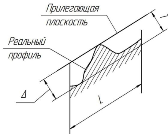
Рис. 2.1.8. Отклонение от прямолинейности в плоскости
