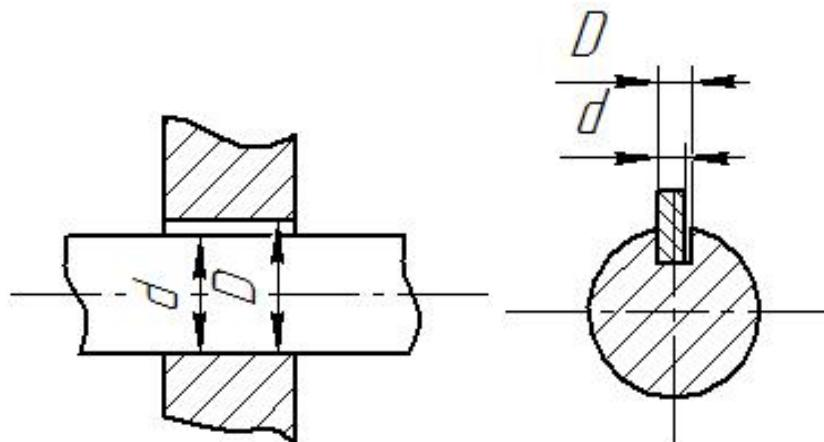
Рис. 1.1.1. Примеры соединений отверстия и вала
