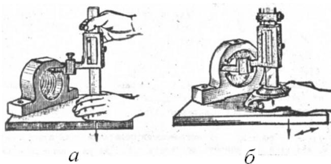
*Рис. 1.2.22. Измерение и разметка штангенрейсмусом:*
