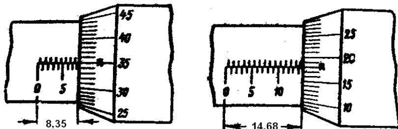
*Рис. 1.2.24.* Примеры отсчёта по шкалам микрометра
