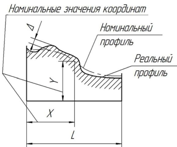
Рис. 2.1.9. Отклонение формы заданного профиля
