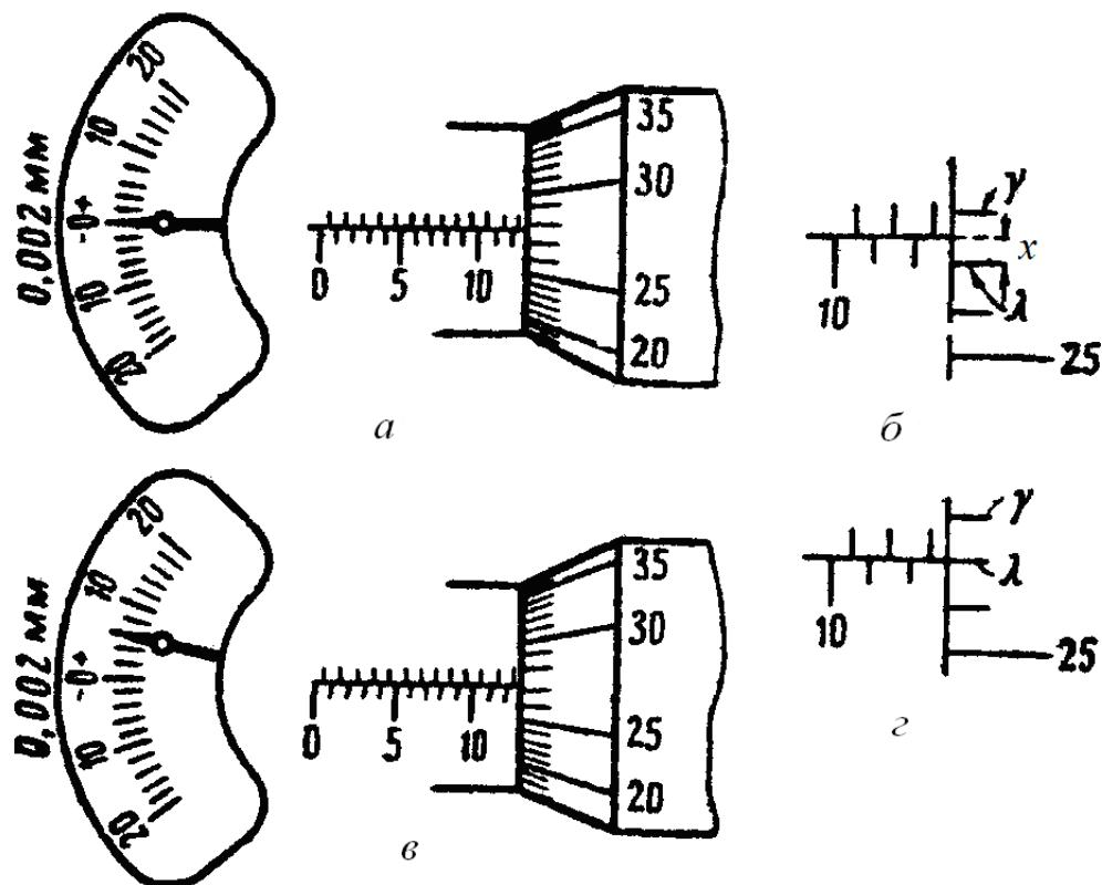
*Рис. 1.2.62. Примеры отсчета по шкалам рычажного микрометра*
