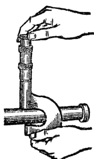
*Рис. 1.2.32. Измерение при вертикальном положении оси микрометра*
