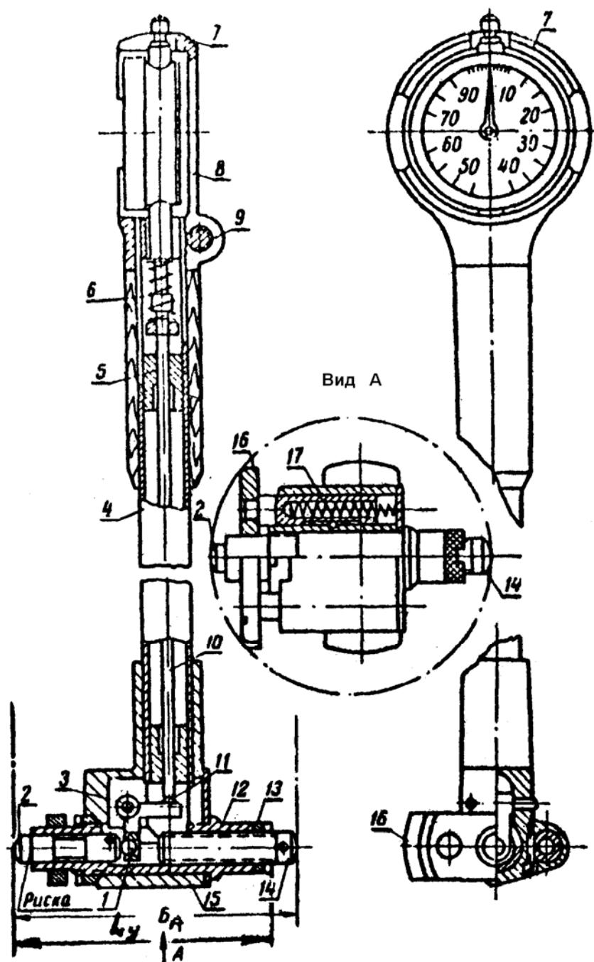
*Рис. 1.2.54. Индикаторный нутромер с рычажной передачей:*
