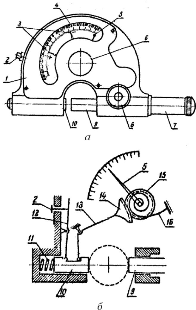
*Рис. 1.2.64. Рычажная скоба (а) и ее принципиальная схема (б):*
